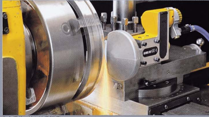
●大径リングの外径研磨 External Grinding
